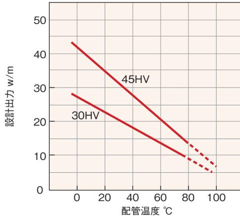
(50Aパイプ、断熱材25mm厚)の設計出力 注1)設計出力は最低保証値です。 注2)配管温度はFヒータの温度ではありません。ご注意ください。
